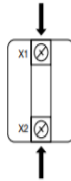
Hình 10: Sơ đồ chân nút dừng khẩn cấp
